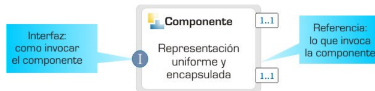
Figura 5.12. Representación gráfica de un componente SCA.
