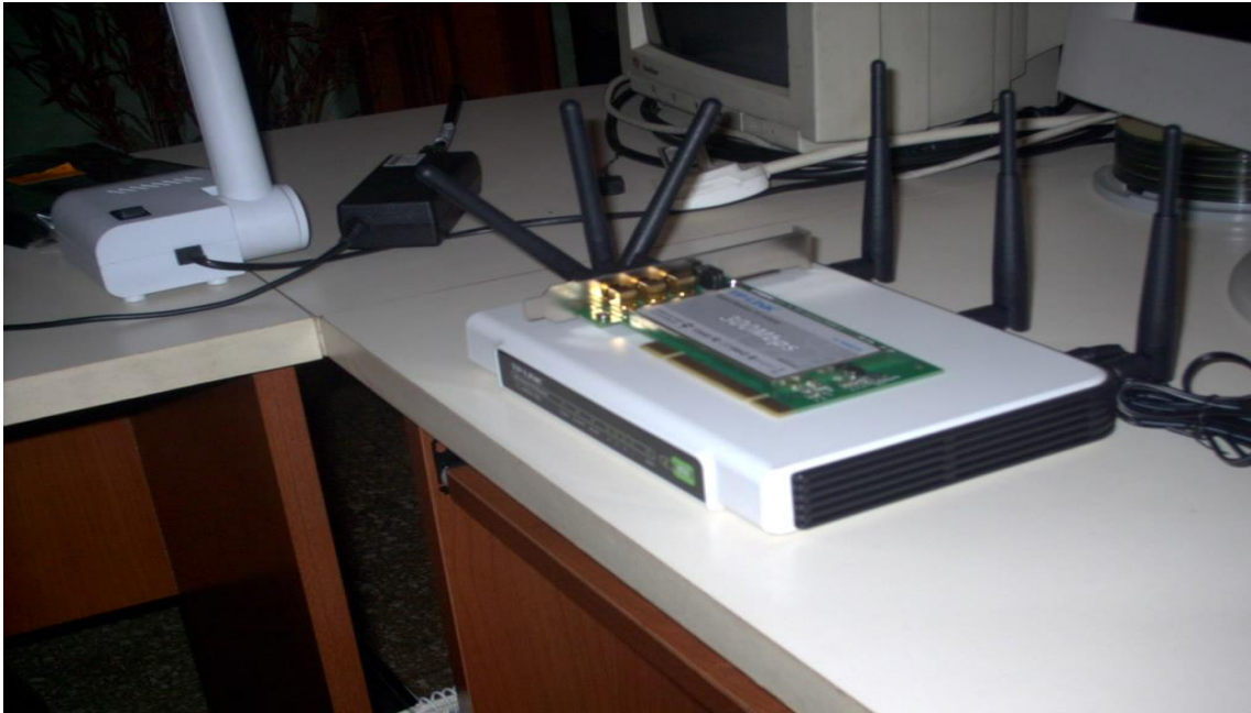
Fig. 9 (Equipamiento 802.11b/g/n 3T x 3R, MIMO, modelo TL-WR941ND, placa PCI modelo TL-WN951N.)
