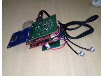
Figura 9: Sistema de adquisición y almacenamiento de sonido.
