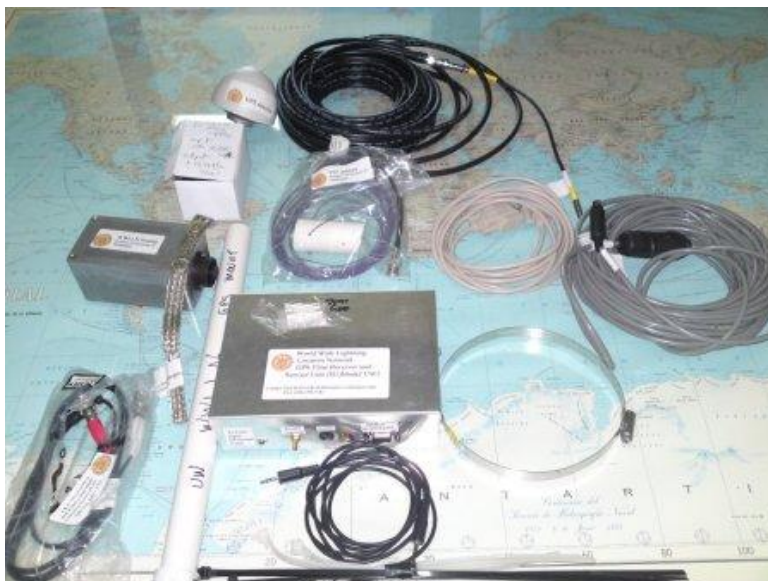
Figura 2-3 Partes del sensor de la WWLLN
