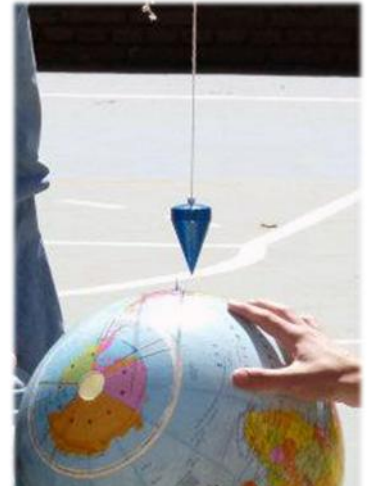
Fotografía 10. Con una plomada se puede poner en evidencia la vertical gravitatoria. Fotografía tomada por Patricia Knopoff en Villa Giardino (Córdoba) en septiembre de 2011.
