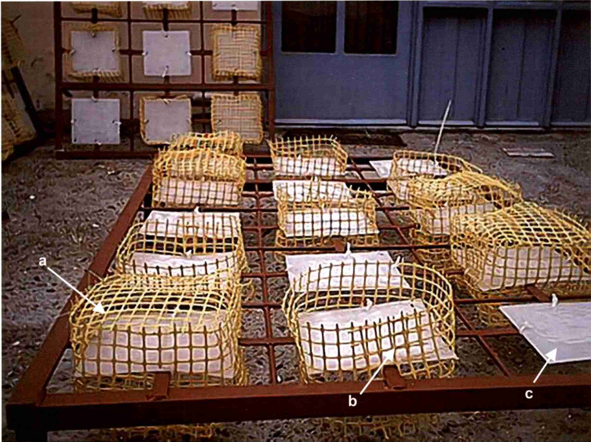
Figura 4. Disposición de los tres tratamientos sobre un armazón de hierro rectangular. a. Panel cubierto: exclusión de depredadores; b. Panel parcialmente cubierto: control metodológico; c. Panel no cubierto, con libre acceso de la megafauna bentónico-demersal.
