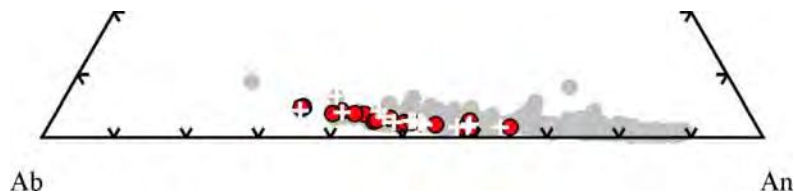
Fig. 72: Composición de las plagioclasas en el Domo riolítico del Complejo Volcánico Salle. Círculos rojos: fenocristales; cruces: microfenocristales. En gris, datos pertenecientes a todas las unidades estudiadas.
