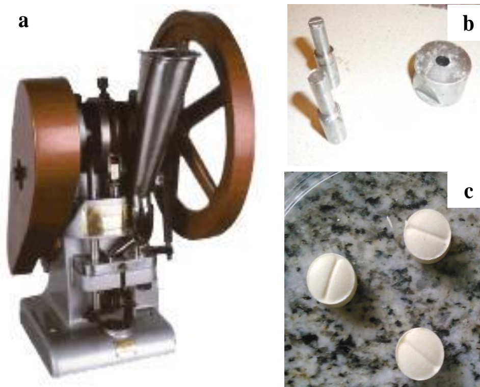
Figura 3.4. Imágenes de (a) máquina compresora mono-punzón, (b) matriz y punzones superior e inferior y (c) tabletas comprimidas.
