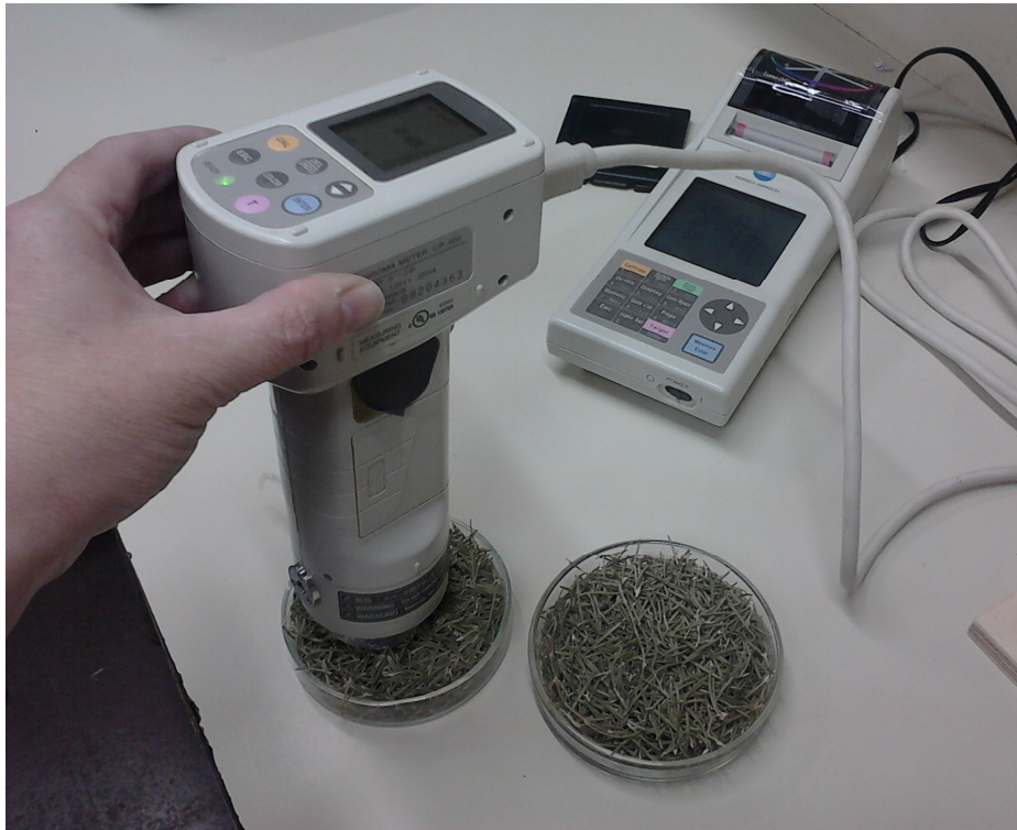
Figura 7: colorímetro de superficie Konica Minolta CR 400. Fuente: CIDCA (UNLP)
