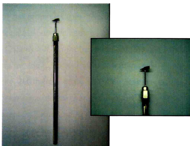
Fig. 8: herramienta utilizada para abrir los caparazones.
