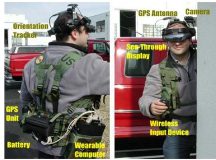
Figura 2.13 - Equipamiento de hardware necesario para cada usuario del sistema BARS
