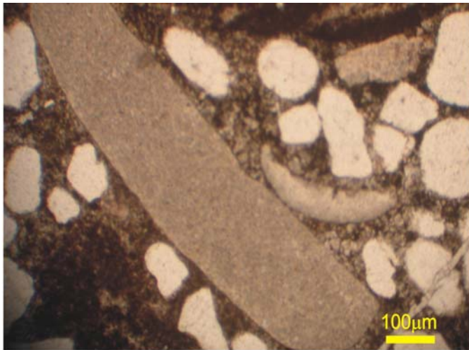
Foto 1. Base de dolomita fina microesparítica a esparítica rica en hierro (Dfe) con clastos de fluorapatita (Fap) con forma prolada, cuarzo monocristalino (Qm).
