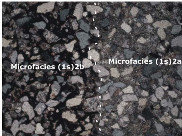
Foto 45. Microfacies M(1s)2 . Predomina el Qm de menos de 500Mc. Se observa un límite entre dos microfacies: a) cemento illita+chert y b) cemento ferruginoso.
