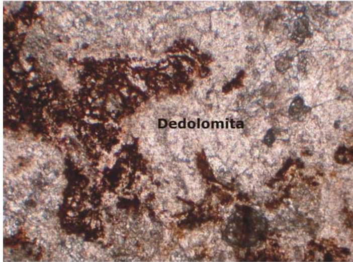
Foto 69. Se reconocen cementos de calcita, chert y hematita en zonas como reemplazo de la dolomita original.
