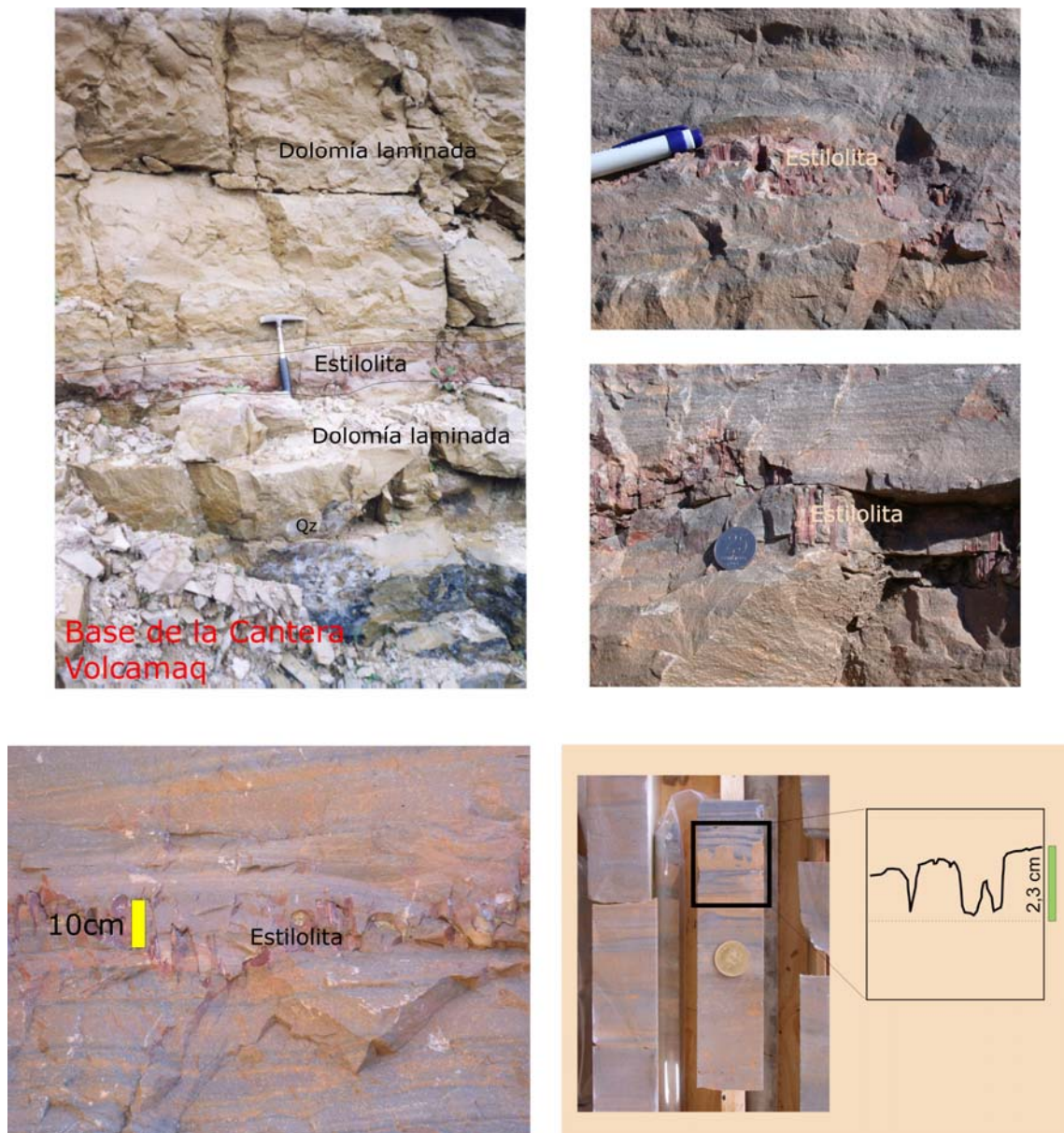
Figura 5D1. Fotos de Campo canteras Volcamaq (1), Tres Antenas (2) y Piedra Amarilla (3), y de testigos de perforación en Cantera El Polovorín que muestran a las dolomías con estilolitas de centimétricas a decimétricas.
