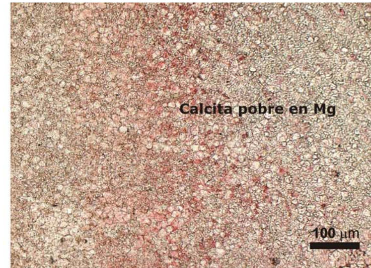
Foto 2. Mudstone rojizo, se observa una base micrítica y zonas constituidas por microesparita (tamaño promedio 15\mu\text{m} ) ambos con textura xenotópica (cristales anhedrales)
