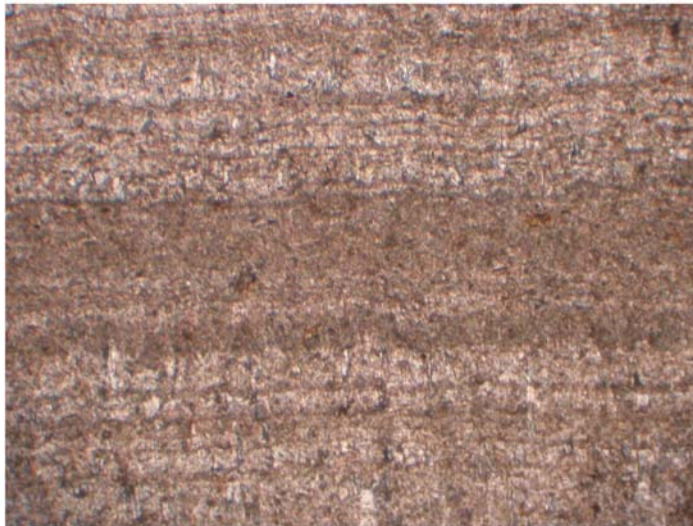
Foto 125. Microfacies 22sM1 . Se observa la microfábrica y textura interna de una concreción carbonática. El ancho vs el largo de los cristales de calcita (en naranja) tienen dimensiones del tipo fibroso, también es bandeado.
