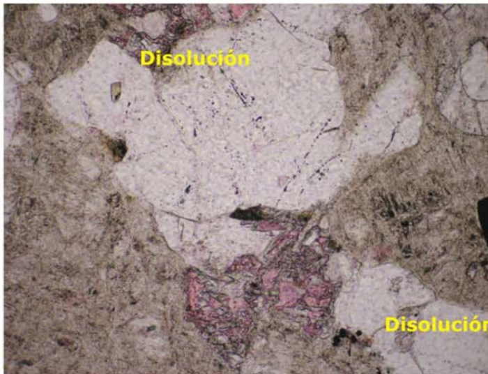
Foto 13. Microfacies 1sM1 . Detalle de crecimiento de cemento calcítico tipo LMC en la matriz arcillosa recristalizada.
