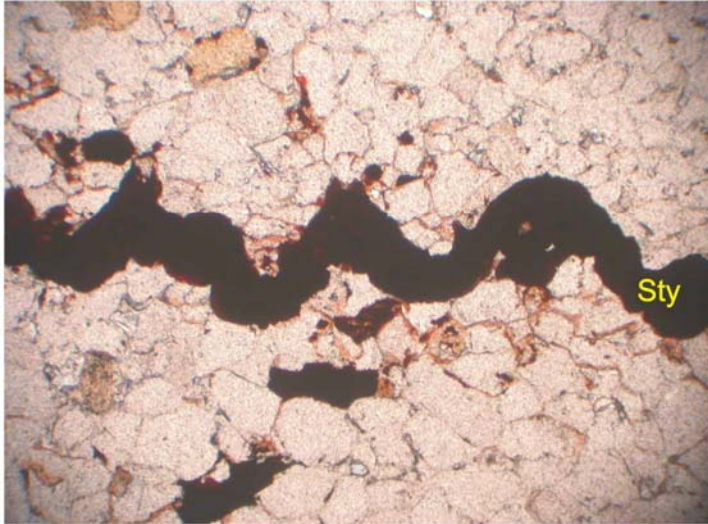
Foto 107. Microfacies 18M2. Los granos de cuarzo son suangulosos. Predomina el cemento ferruginoso que se concentra en la estilolita de forma meandrosa.
