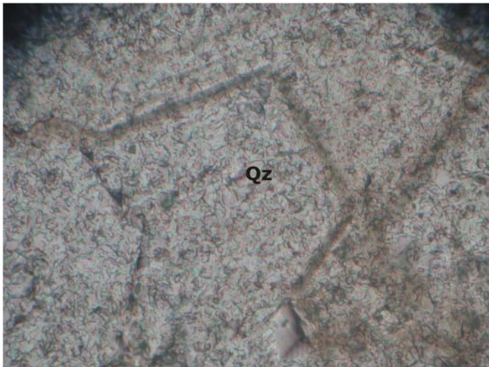
Foto 55. Detalle de los cristales de cuarzo ehedrales, pueden observarse por lo menos 7 pulsos de cementación
