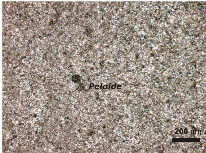
Foto 1. Mudstone rojizo de la base (MR 2,6): base de micrita y microesparita fina (tamaño de grano menor a 10\mu\text{m} ) con textura no-planar xenotópica bastante equigranular.
