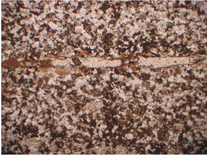
Foto 123. Microfacies 21sM1 . Limolita cuarzosa con escasa matriz illítica asociada a cementos ferruginosos. Paralela a la estratificación se observa una venilla con cemento de opalo.
