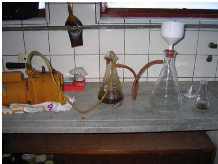
**Foto 12.** Secado de la muestra por bomba de vacío
