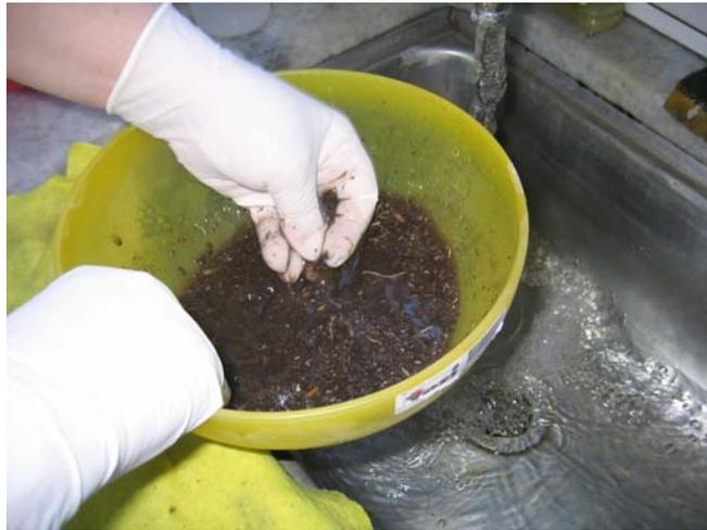
**Foto 9.** Degranulación de la muestra de tierra
