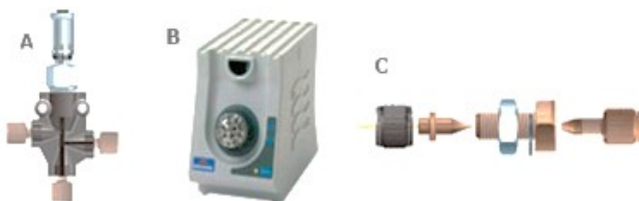
Figura III.27. Imágenes de los 3 módulos que complementan a las bombas y detector convencional de HPLC. A) Válvula divisora de micro-flujo, B) Válvula de 6 vías de nano escala, y C) Puerto de micro-inyección.
