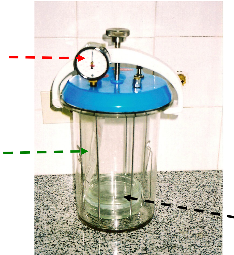
Fig.3.10- Jarra de anaerobiosis (la flecha verde indica el sobre con el catalizador, la flecha negra señala las cápsulas de Petri con los cultivos y la flecha roja muestra el manómetro que mide la presión).
