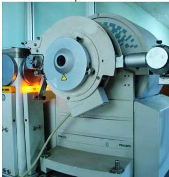
Figura 2.1: Difractómetro Philips 3020 modelo PW 10 usado para el estudio por DRX.
