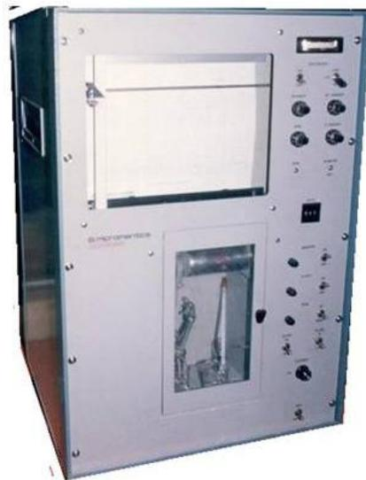
Figura 2.2: Equipo para la medición de la distribución de tamaño de partícula.
