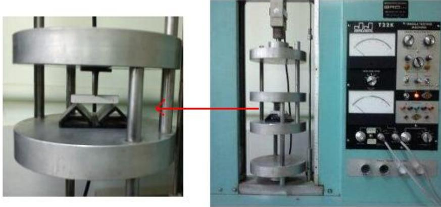
Figura 2.14: Ensayo de Módulo de Rotura (MOR) por flexión en tres puntos.
