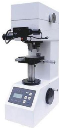
Figura 2.11: Durómetro de Buehler.
