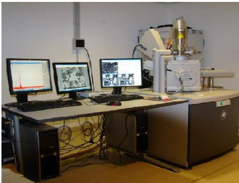
Figura 2.3: Microscopio de barrido electrónico.
