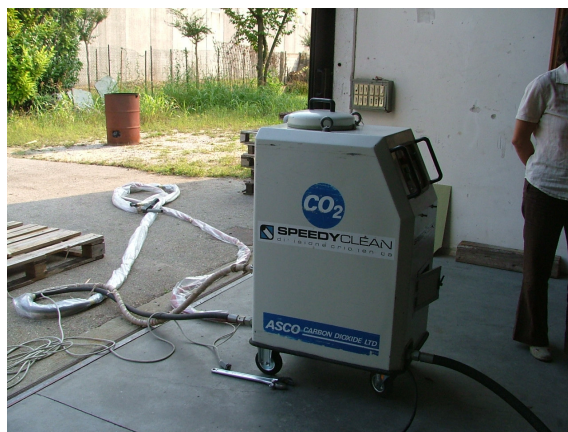
Fotografía 1. Equipo de criareado. Se observa el tanque de reserva de CO2 congelado y granulado.
