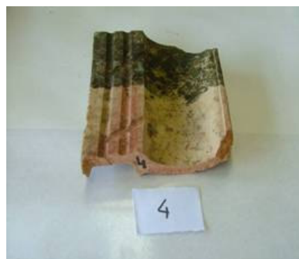
Fotografía 6: Teja de 120 años antes del crioarenado a 3.5 bar
