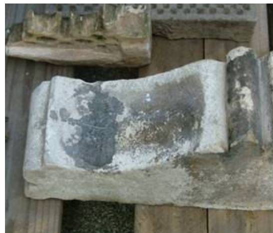
Fotografía 17: Ornamento de arenisca luego del crioarenado a 3.5 bar
