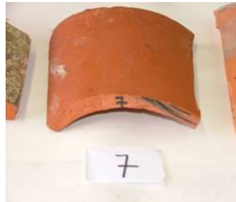
Fotografía 12: Teja de 60 años luego del crioarenado a 1.5 bar
