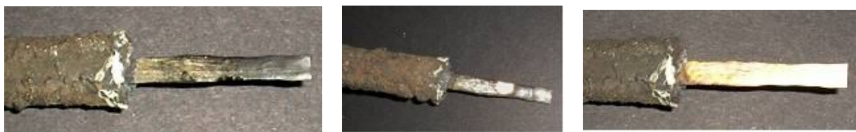
Figura 13. Limpieza con láser de estructura interior del mango de la cuchara a) antes de la limpieza. b) limpieza parcial. c) Pieza limpia.
