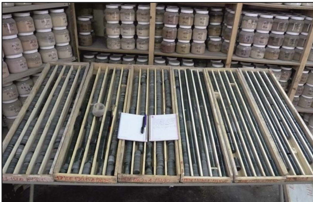
Figura II.3: Testigos de perforación (Perfil TA 22).
