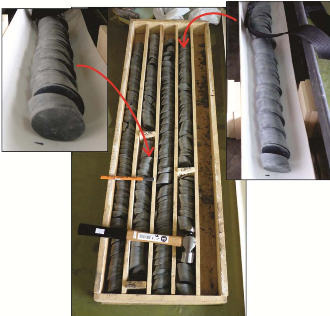
Figura II.4: Testigos de perforación de diámetro \varnothing NQ, donde se observa la abundante laminación que imposibilitó seccionar el testigo por la mitad (Perfil TCA 10).
