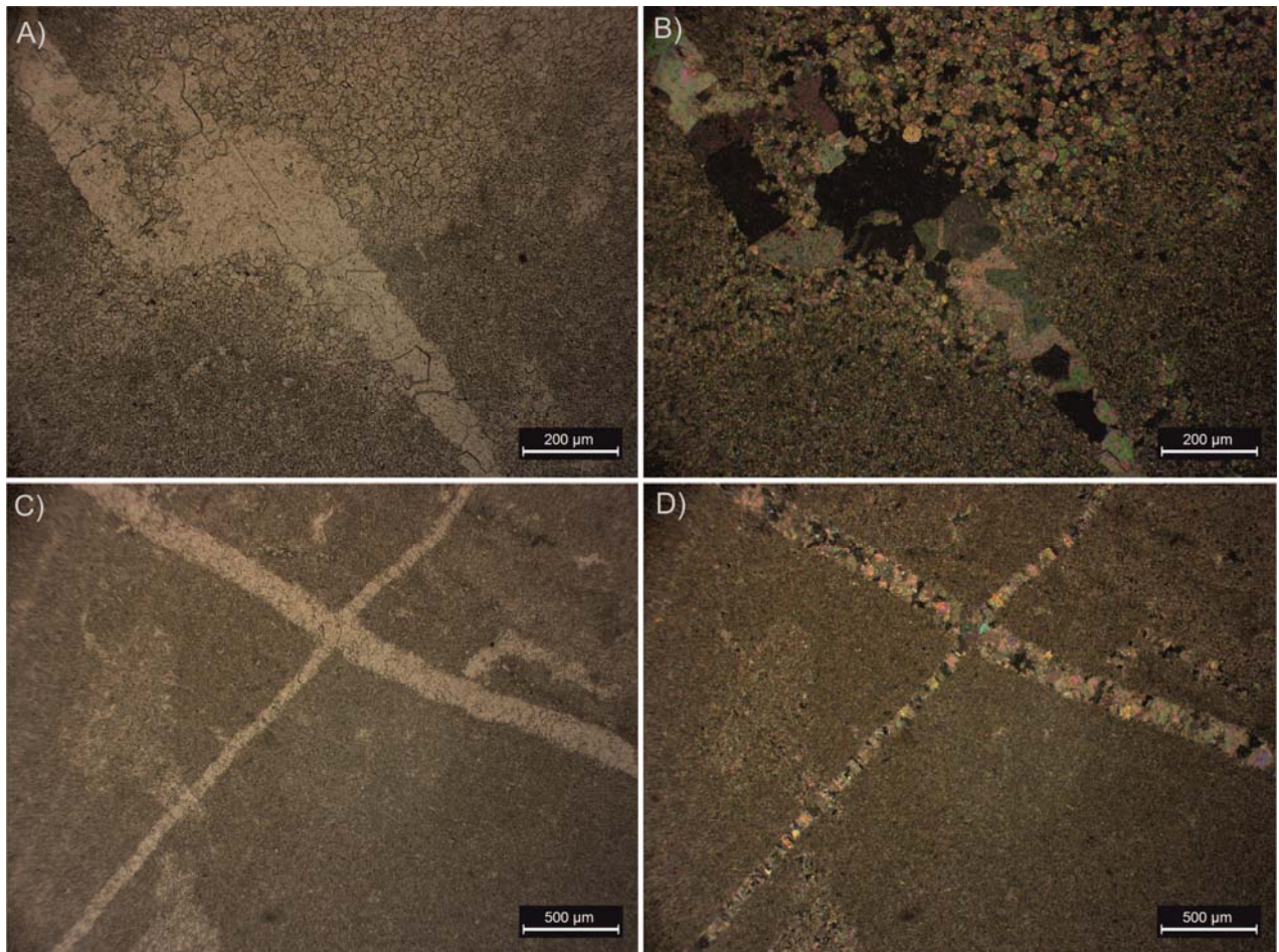
Figura V.1: Microfotografías de margas. A) Sin nicoles y B) Con nicoles cruzados pertenecientes al Testigo TA 23: Se observa una mezcla de material micrítico y en menor proporción de material arcilloso que es atravesado por una vetilla de calcita recristalizada de ancho > a los 5\ \mu\text{m} , y que pueden llegar a los 200\ \mu\text{m} . C) Sin nicoles y D) con nicoles; se distingue una mezcla de material pelítico y micrítico, atravesado por vetillas de calcita esparítica.
