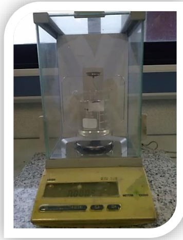
Fig.6.1.1: Balanza analítica donde se realizaron las medidas de densidad.
