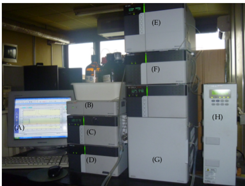
Figura 35: Fotografía del equipo HPLC Shimadzu Prominence LC-20A: (A) PC y software para el análisis de los datos ( LC Solution ) (B) desgasificador; (C) módulo de distribución de solventes; (D) módulo controlador; (E) detector de fluorescencia (FL); (F) detector UV/vis (PDA); (G) inyector programable; (H) horno y columna.
