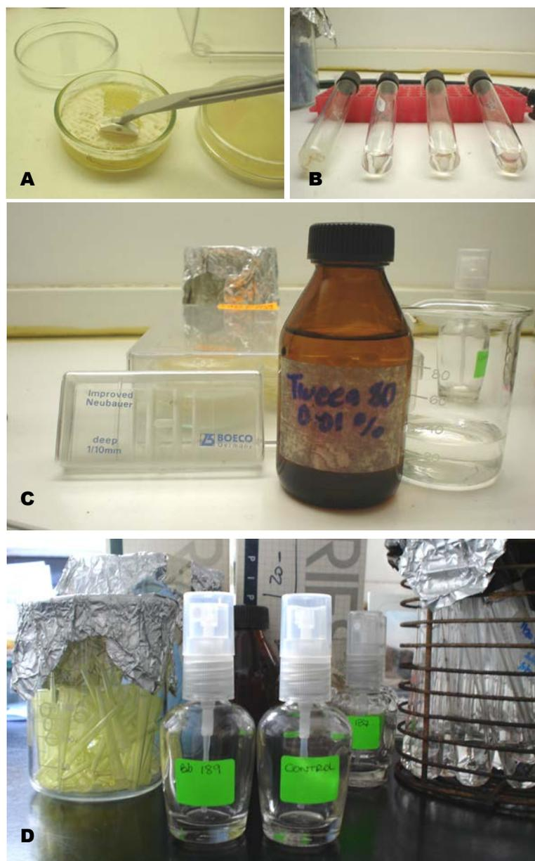
**Fig. 3:** Preparación de una suspensión de conidios a partir de aislamientos fúngicos mantenidos en medio de cultivo sólido. **A:** Cosecha de conidios a partir de cultivos sólidos. **B:** Tubos de vidrio con tapa a rosca conteniendo cada uno 5 ml de Tween 80. **C:** Cámara de Neubauer para el recuento de propágulos de la suspensión a inocular. **D:** Aspersores de vidrio para realizar las aplicaciones.
