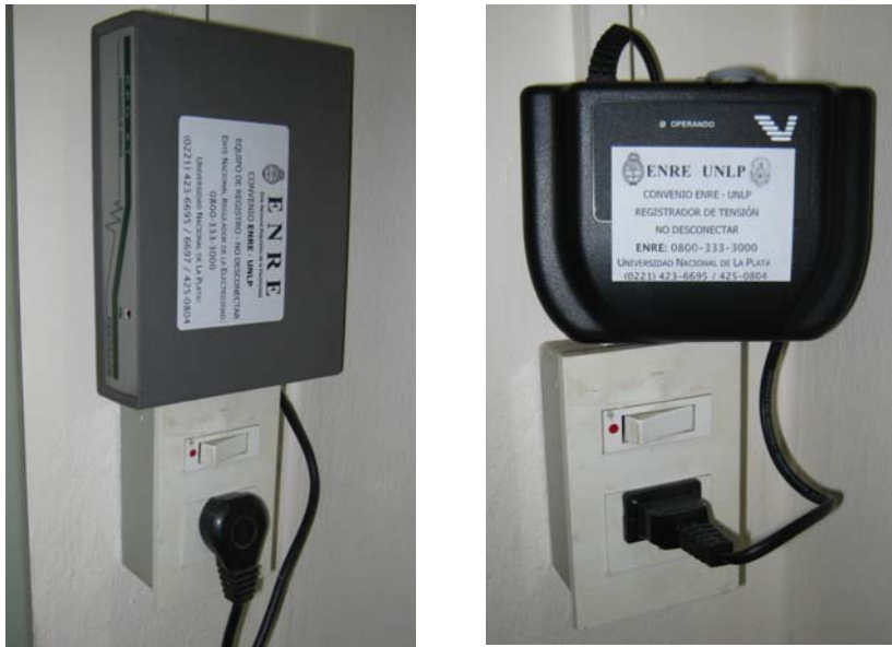
Figura 44. Registratori di interruzioni della fornitura di energia elettrica, due generazioni diverse.
