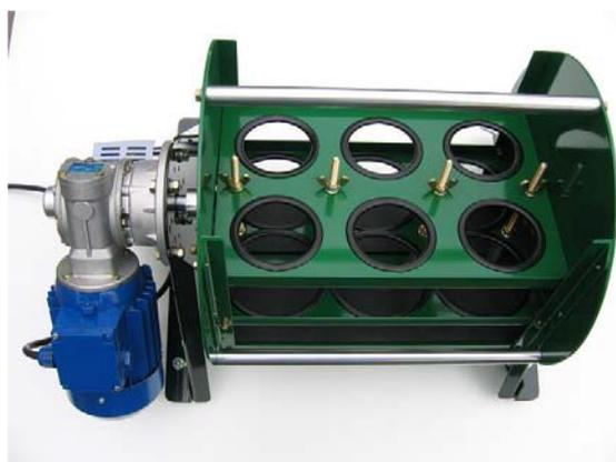
Foto 10.2. Equipo de agitación empleado en el test 1311.
