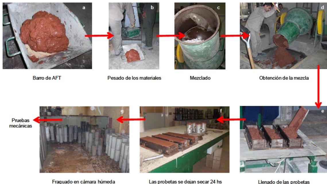
Figura 10.6. Esquema de preparación de las probetas.
