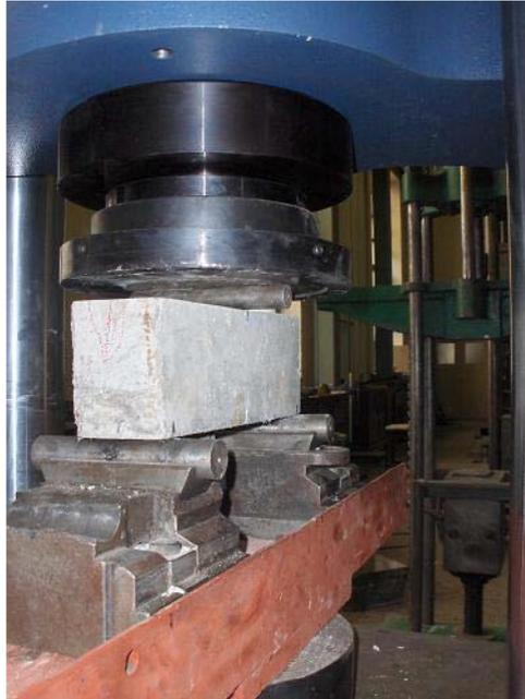
Foto 10.1. Equipo empleado en la determinación de la resistencia a flexión.
