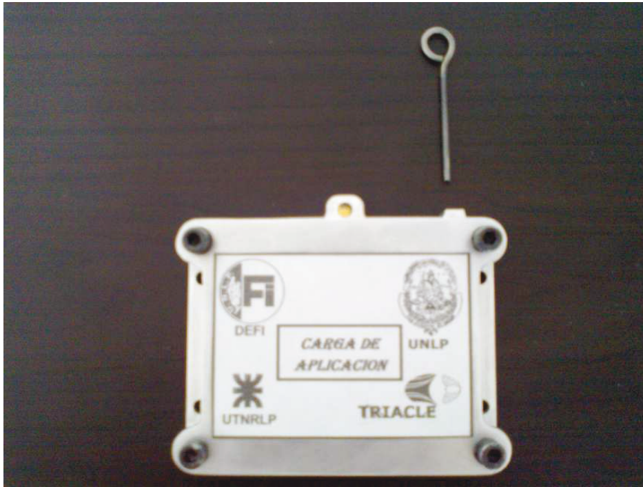
Figura 4.23. Carga de aplicación desarrollada para el ensayo de instrumental meteorológico en un vector de lanzamiento
