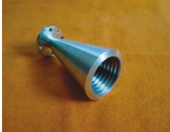
Figura 6.4. Bocina corrugada de microondas en la frecuencia de 36.5Ghz
