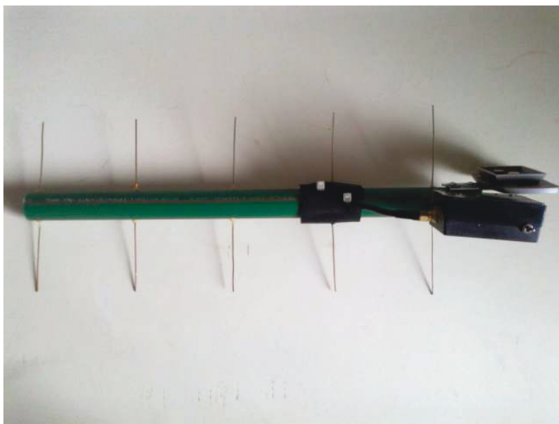
Figura 4.37. Prototipo de la antena YAGUI-UDA para la frecuencia de 868Mhz
