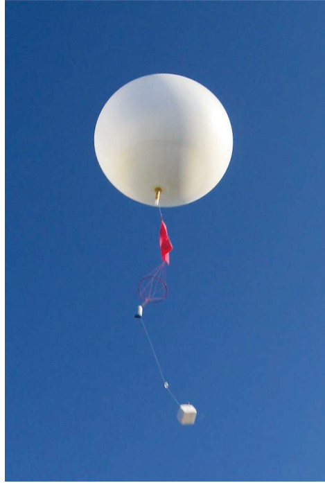
Figura 3.4. Lanzamiento de Radiosonda donde se observa el devanador, y el paracaídas en color rojo.
