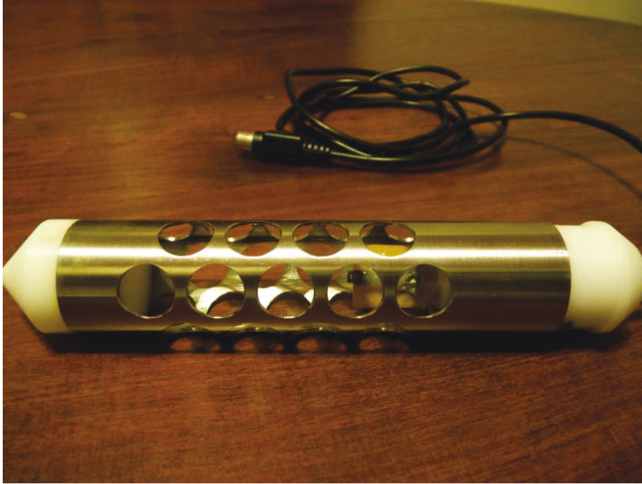
Figura 4.15. Capsula protectora del sensor de temperatura y humedad
