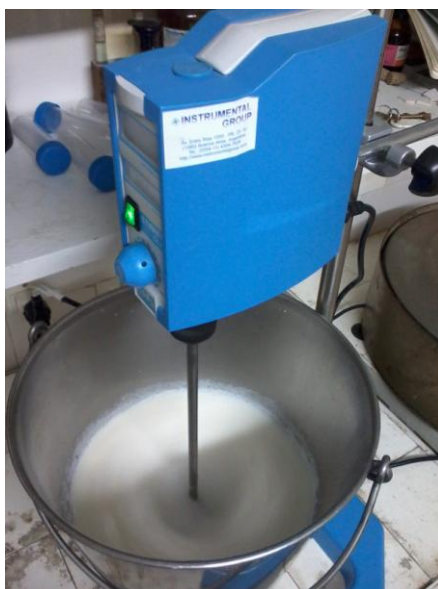
Figura 7-1. Agitador empleado para la disolución de goma xántica en leche
