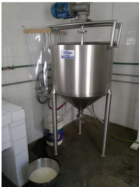
Figura 7-2. Paila dulcera abierta de doble camisa utilizada para elaborar el dulce con agregado de aceite de nuez pecan.
