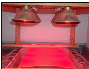
Figura 5.4. Imágenes que muestran el equipamiento utilizado durante el procesamiento de películas proteicas de soja secadas por radiación IR.
