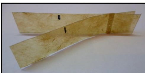
Figura 5.6. Disposición de las probetas de película termoselladas para medir la resistencia del sellado empleando un texturómetro.
