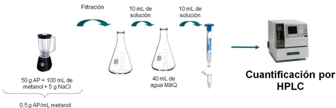
**Figura 3.2.** Esquema experimental de la extracción de aflatoxina B<sub>1</sub> del alimento para pollos.
