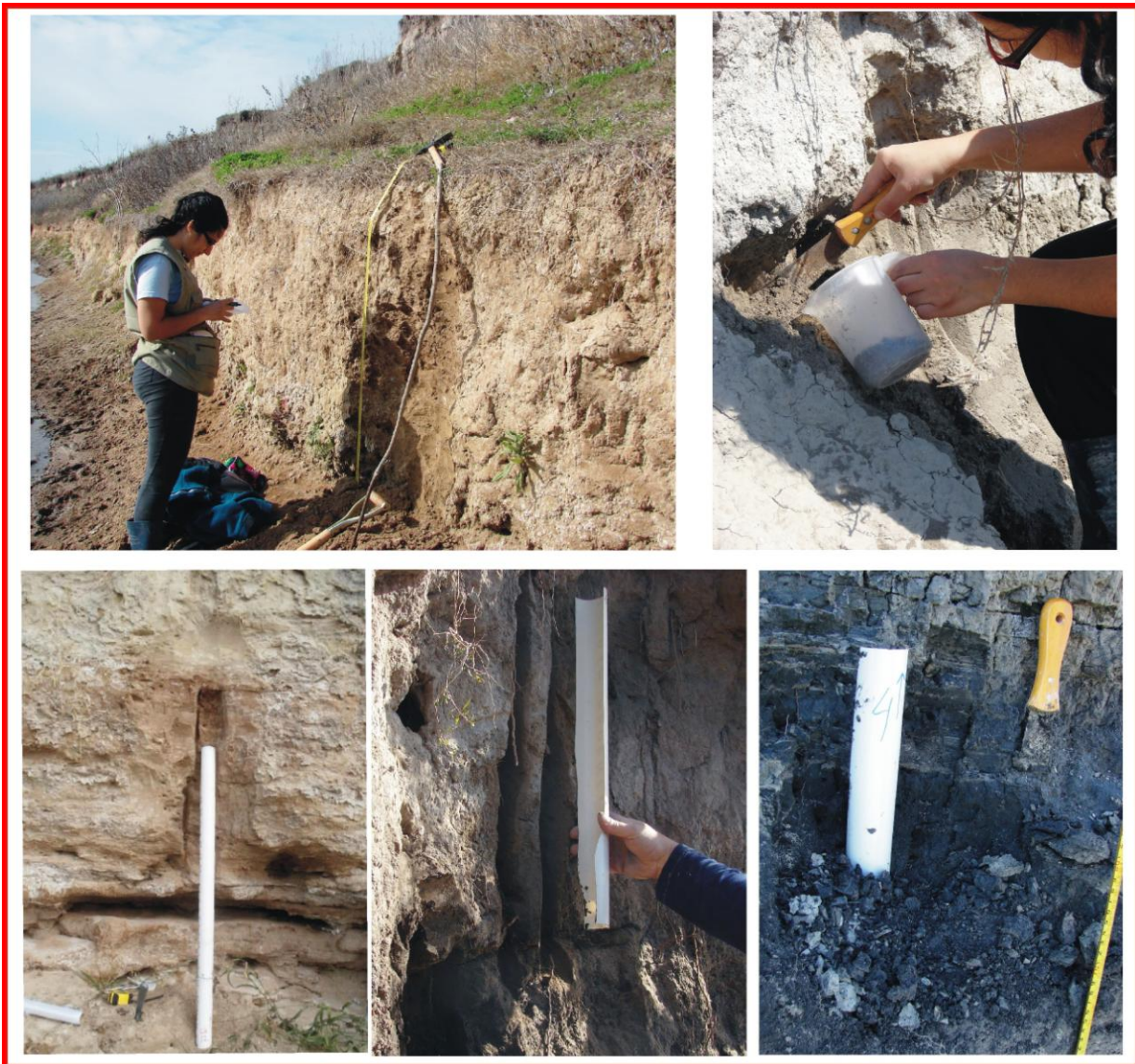
Figura 4.1: Metodología de muestreo. Arriba, muestreo estratificado y aleatorio. Abajo, extracción de testigos continuos.
