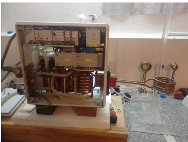
Figura 3. 7. Izquierda: Circuito resonante RLC utilizado para producir el campo magnético de radiofrecuencia sobre la muestra. Derecha: Se observa la disposición del coloide dentro del portamuestras centrado respecto de la bobina.
