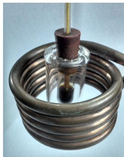
Figura 3. 7. Izquierda: Circuito resonante RLC utilizado para producir el campo magnético de radiofrecuencia sobre la muestra. Derecha: Se observa la disposición del coloide dentro del portamuestras centrado respecto de la bobina.
