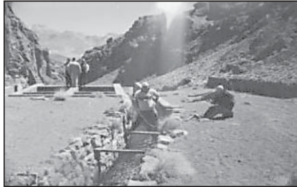
Figura 37 Medición de caudal en el canal principal
