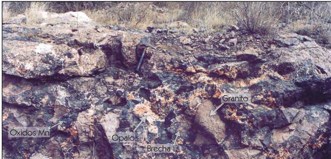
**Figura 5.8.** Fotografía tomada en un frente destapado por las labores de explotación en la veta “La Clemira” donde se observa la denominada Brecha II, constituida por clastos de diverso tamaño de granito y de Brecha I, en un cemento de óxidos de manganeso e importantes cantidades de ópalo de color rosado y blanco acompañados por cantidades accesorias de baritina, observables a escala microscópica.
