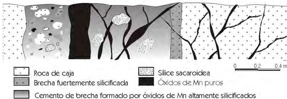
**Figura 5.17.** Perfil esquemático de una veta donde se observan las diferentes tipologías en que puede presentarse la mineralización de manganeso.
