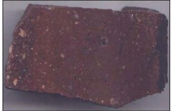
**Figura 5.3.** Muestra de mano correspondiente a la denominada "Brecha I". Se observan clastos redondeados de feldespato y cuarzo provenientes del granito en un cemento silíceo de color rojo intenso.
