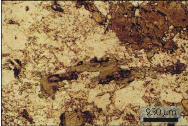
**Figura 3.7.** Tonalita Quebrachos Colorados. Se observan cristales de hornblenda, cuarzo y plagioclasas con leve alteración argílica. N//.
