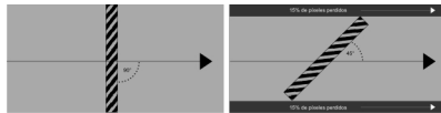
Figura 5. Dos superficies del mismo tamaño ocupan menos píxeles a causa del ángulo de incidencia
