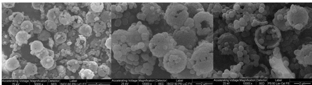
Figura 4.11 Micrografías SEM de microsferas de sílice obtenidas utilizando 7 ml de \text{NH}_4\text{OH} (28% (p/p)) luego de 6 h de recubrimiento y posterior eliminación de la plantilla. Magnificación: 5000x y 10000x.
