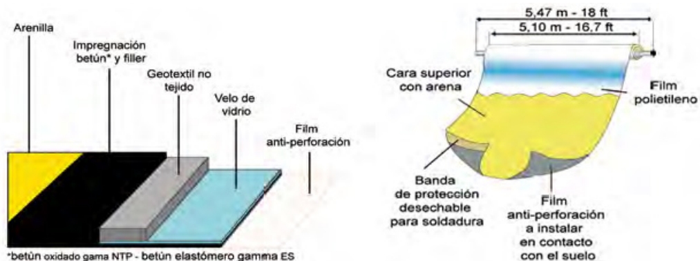
Ilustración 1. Composición de las membranas asfálticas
