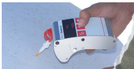
Figura 18.1. Muestreo del nivel de O y CO con un medidor portátil de gases.
