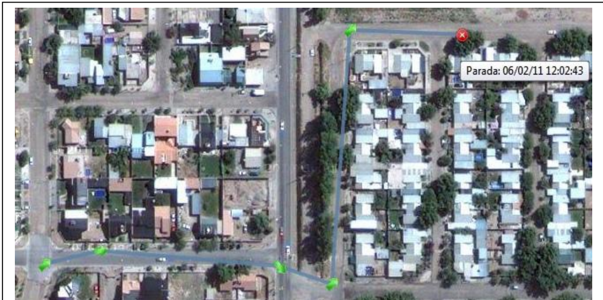
Figura 22: Itinerario dibujado sobre el mapa, cada flecha indica la dirección del vehículo en el momento en que se genera el evento.
