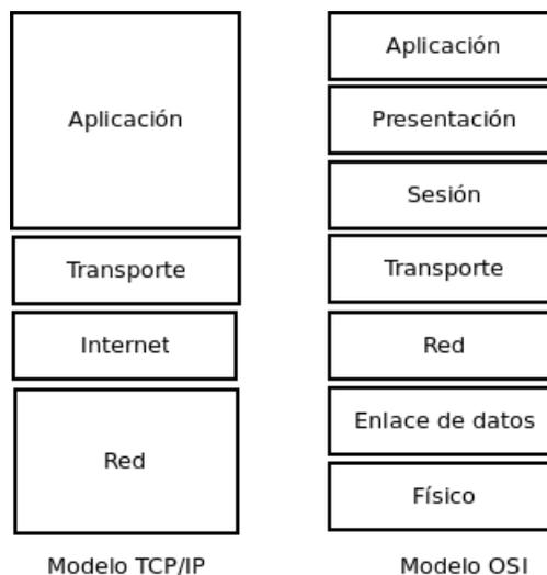
Figura 4.1: Gráfico comparativo entre los modelos OSI y TCP/IP.
