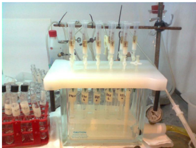
Figura III.1. Separación de la fracción lipídica neutra por cartuchos de extracción en fase sólida.
