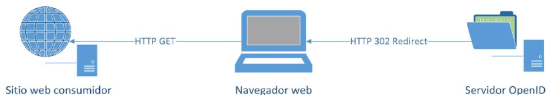
Figura 4.7: Flujo del mensaje de respuesta checkid\_setup
