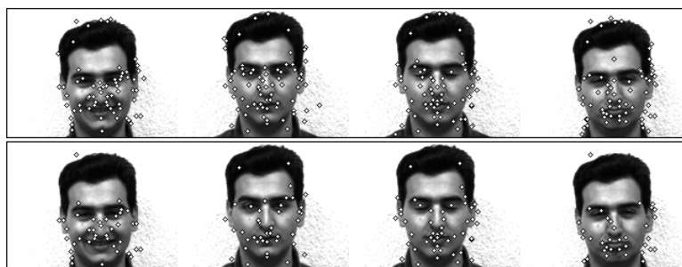
Figura 5.4: Descriptores SIFT de una persona de la base de datos YALE. La fila superior muestra todos los descriptores encontrados, mientras que la fila inferior muestra sólo los descriptores seleccionados por el método propuesto.
