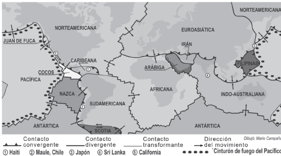
1 - Subdivisión de la corteza terrestre en las principales placas tectónicas y los diferentes contactos entre las mismas (convergente, divergente y transformante). Obsérvese que algunas placas (por ejemplo, la Sudamericana) están compuestas por zonas continentales y oceánicas. La actividad sísmica principal marca los límites de placas. Se señala la ubicación de las regiones de Haití, Maule (Chile), Japón, Sri Lanka, California y el "cinturón de fuego del Pacífico".
