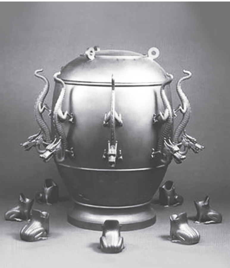
3 - Sismógrafo antiguo utilizado en la China para saber la magnitud y dirección de propagación de una onda sísmica. Dependiendo de la cantidad de bolillas que caían y en qué sapito, se podía estimar la importancia y orientación del terremoto.
