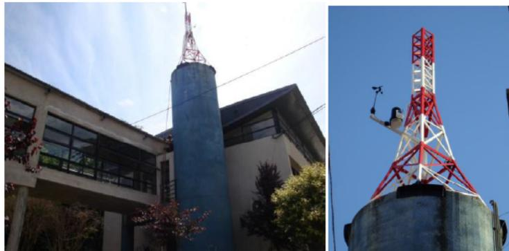
La estación meteorológica cuenta con un receptor inalámbrico, el cual ofrece la posibilidad de ser conectado a una PC para almacenar los datos de forma continua sin agotar la memoria del equipo. La central se configuró para tomar valores cada 5 minutos para obtener una aceptable resolución en los datos.
