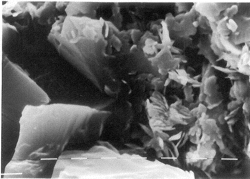
Foto III.11.- Agregado de caolinita y illita en estos mudstones negros (SEM, barra= 10 micrones).
