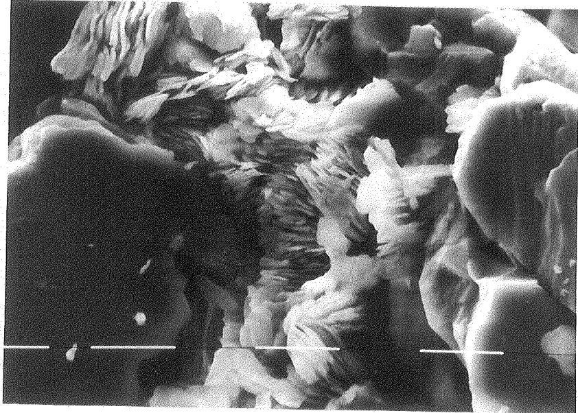
Foto III.4.- "Libros" de caolinita en arenitas cuarzosas con disposición preferencial, perpendicular a los granos de cuarzo y con una leve deformación (flexura) (SEM, barra= 10 micrones).
