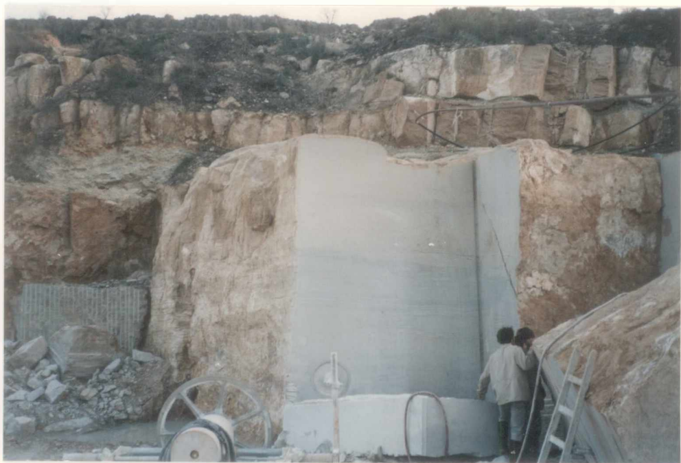
Foto II.7.- Facies de dolomías laminadas, vistas en un corte liso de explotación en bloques. Por arriba, bioestromas dòmicos con pelitas verdes intercaladas (Cantera "Malegni").
