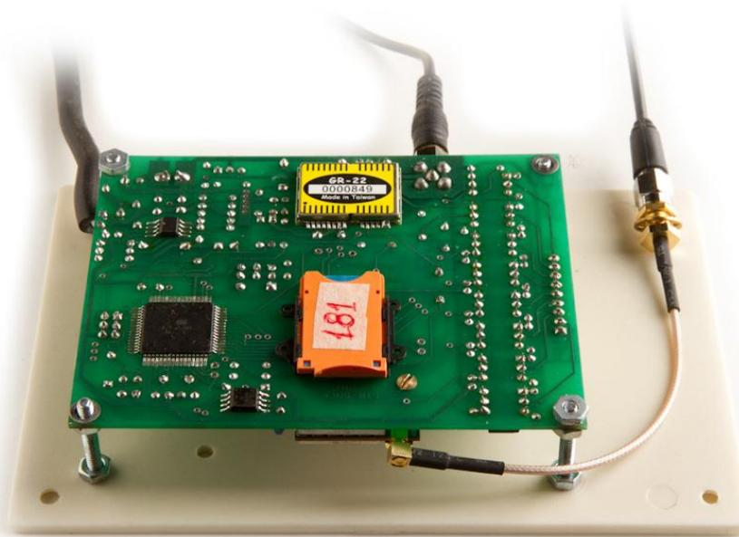
Figura 2.2. Plaqueta GSM SK1000 para monitoreo satelital (suministrada por SkyControl SH)
