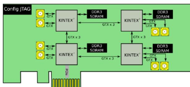
Figura 2: Topología cubo utilizando buses de alta velocidad propios de las FPGAs de generación 7
