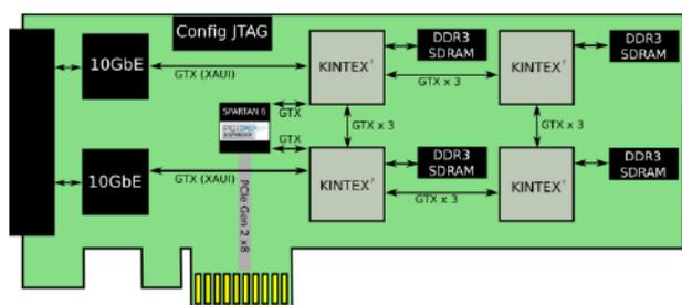
Figura 1: Topología Backplane / Gigabit ethernet
