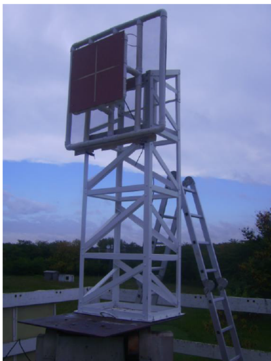
Figura 1: Prototipo construido de la Antena Ranuras Cruzadas Impresas sobre Sustrato de Circuito Impreso FR4.
