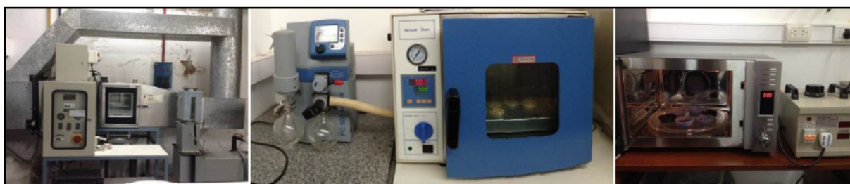
Figura 2. Equipos utilizados en la elaboración de las golosinas. De izquierda a derecha: túnel de bandejas, estufa de vacío y horno de microondas.
