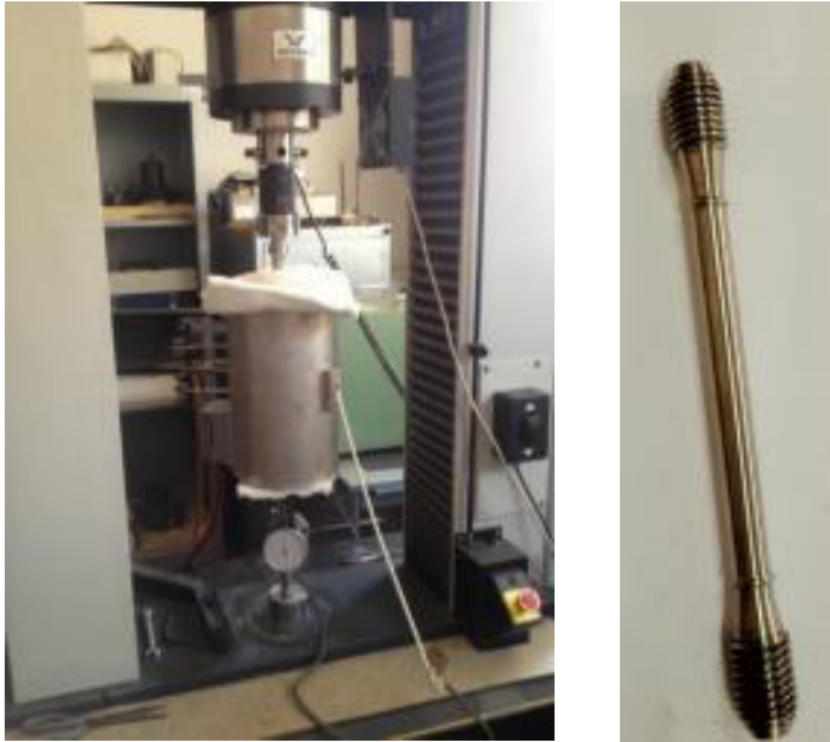
Figura 1. Máquina Instron y horno para ensayos de tracción (izq.) y probeta (der.).
